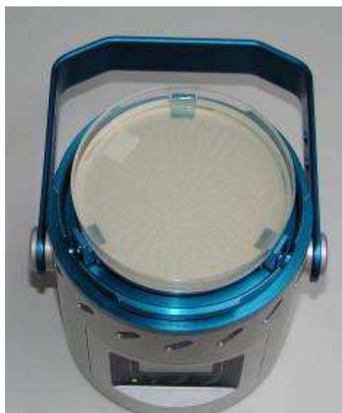
Slika 8: Vzorčevalnik zraka z gojiščem za štetje skupnega števila mikroorganizmov
