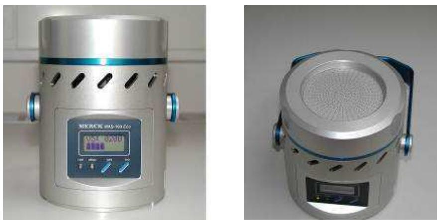
Slika 7: Naprava za bakteriološko analizo zraka (MAS 100 Microbial Air Monitoring Systems®) (foto Š. Pintarič).
