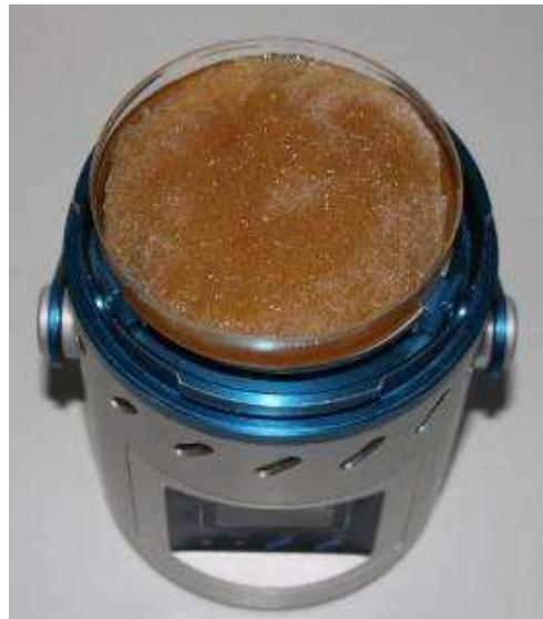
Slika 9: Vzorčevalnik zraka s tkočim gojiščem za preiskavo na bakterije iz rodu *Listeria*
