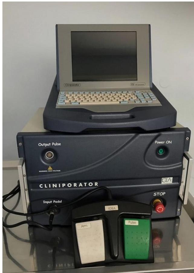
Slika 6: Generator električnih pulzov (Cliniporator, IGEA S.r.l.): Opremo sestavljata generator električnih pulzov z ekranom in stopalka za sprožanje električnih pulzov.
