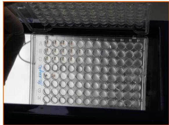
Slika 10 (desno): Mikrotitrská plošča ESB1F.
